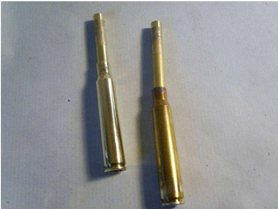
**coller les tubes dans les douilles le morceau coté projectile.**
